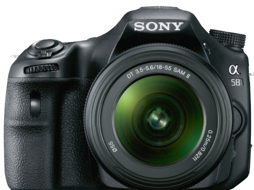
Цифровая зеркальная фотокамера SONY ALPHA SLT-A58* с байонетом Minolta A матрица 20.4 мегапикселей (23.5 x 15.6 мм) объектив 18-55мм в комплекте съемка видео Full HD поворотный экран 2,7"
