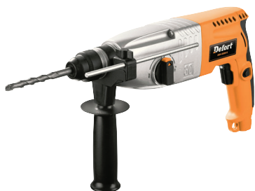
Перфоратор горизонтальный в кейсе DEFORT DRH800 арт. 231987 мощность: 800 Вт 3 режима работы (сверление, сверление с ударом, долбление) скорость холостого хода: 0-780 об./мин количество ударов 0-3900 в мин
