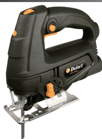
Лобзик сетевой DEFORT DJS-725N-L арт. 428858 мощность 710Вт частота движения пилки 3000 об/мин длина хода 80 мм глубина пропила дерева/ стали/ алюминия - 80 мм/8 мм/8 мм лазерная направляющая
