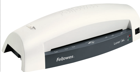
Ламинатор LUNAR FELLOWES формат А4 скорость ламинирования 30см/мин время нагрева 6 мин диапазон пленок 75-80 мкм арт.558768
