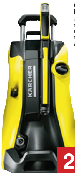
АВД KARCHER K4 Basic арт. 604964 мощность 1,8 кВт давление 20-130 бар производительность 420 л/час аксессуары в комплекте
