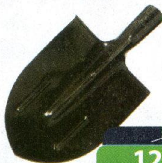
ЛОПАТА ШТЫКОВАЯ, без черенка, сталь рельсовая, остроконечная, лак 1,5мм, 0,75кг
