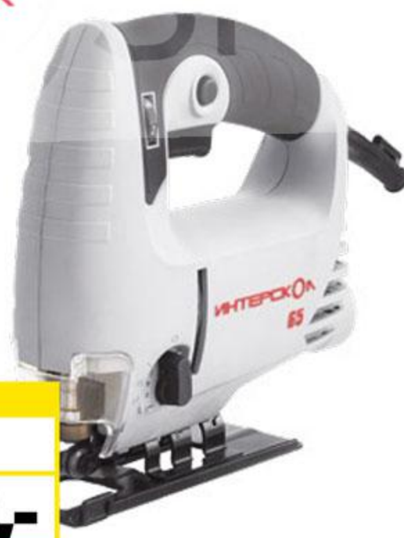
Электролобзик Интерскол 65/550Э, 550 Вт, 300/3000 ход/мин, дерево 65 мм, металл 10 мм, вес 1,9 кг, арт. 3959194
