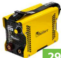
Сварочный аппарат инверторный KOLNER, KIWM 190, 3.5 кВт, 190 А, электрод, дуговой, ПВ 80 %
